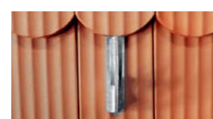
Le crochet de sécurité SH AGZ est testé selon EN 517 Modèle B: le crochet de sécurité SH AGZ peut être utilisé dans toutes les directions de contraintes, c'est-à-dire sur le toit en pente non seulement tourné vers le chéneau, mais aussi vers le débord et le faîte, ou par-dessus le faîte. Il est possible de cette manière d'évoluer librement sur le toit dans toutes les directions ou encore de franchir le faîte.
